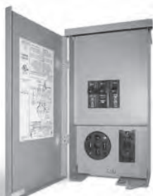
CESMPSC55GRHR NEMA 5-20R2 GFCI, NEMA 14-50. Breakers: 1P 20A, 2P 50A.
